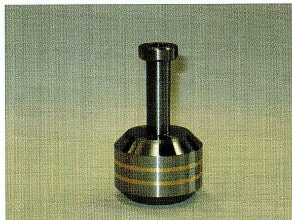
図4 一輪挿し (3) 真鍮線埋め込む
