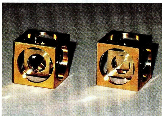
図6 外側13mm フライス盤だけで加工。ぎりぎりまで加工すれば、中の立方体を外せる
