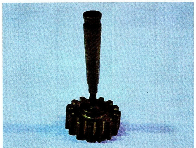
図6 旋盤で加工、下側からばね入り
