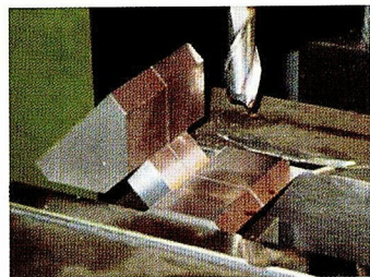
図2 45度の部分をVブロックで加工
