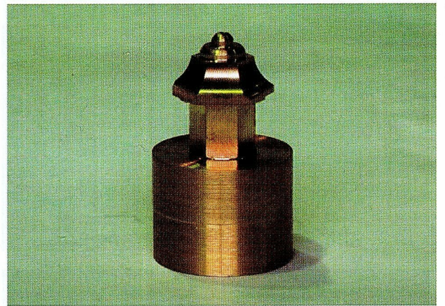
図 3 φ 10 のエンドミルで中心部を加工
