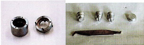
図3 球を固定する治具と切り離し用のバイト
