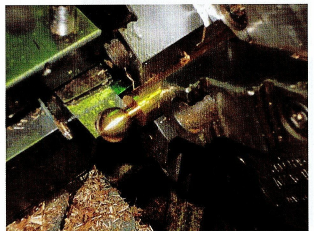
図6 球に加工後、金ノコで切り離す
