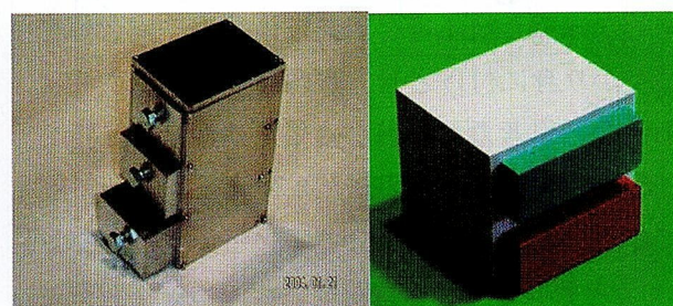
図4 ねじ止め 側面2か所はめ込み
